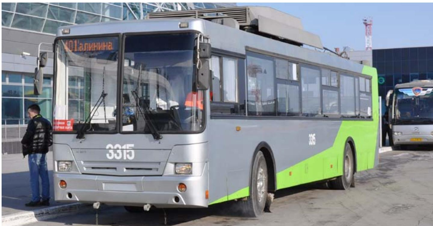
Успешно эксплуатируется в Новосибирске. Дальность автономного хода от одной зарядки аккумулятора – 60 км. Литий-ионные аккумуляторы и энергоэффективный асинхронный привод дают возможность экономить электроэнергию, обеспечить транспортную доступность отдаленных районов и преодолевать дорожные препятствия, не создавая заторы на городских магистралях.
